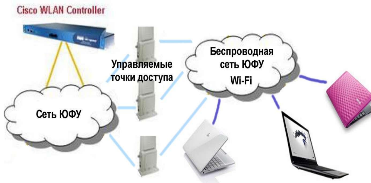
Рис. 4.2.7 - Схема работы беспроводной сети ЮФУ
